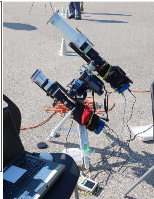
【図4】赤道儀に搭載した2台の分光器
